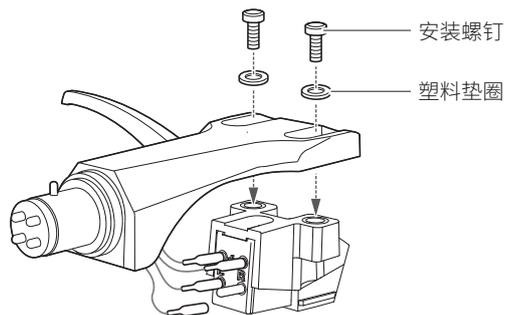
6. 使用另购非金属一字螺丝刀拧紧两处螺钉, 然后调整超距。
