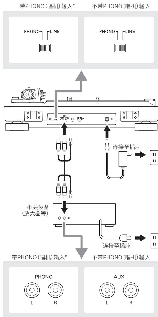
\* 根据所连设备的不同，唱机输入插孔附近可能存在接地端子。在这种情况下，使用RCA音频线缆的接地线连接至该端子。这样可防止播放过程中出现嗡嗡声。
